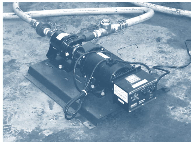
Figure 34. DAT volumetric pump.
